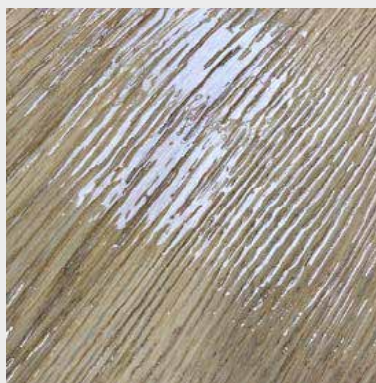
Rys. 3: Drewno otwartoporowe po 1. kroku procesu POREGUARD.
